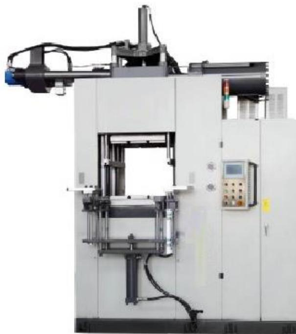
**2-RT вариант (система выезда пресс-форм из рабочей зоны и ее раскрытия)**
